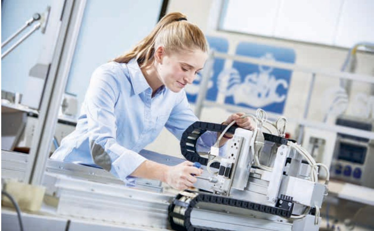
Eine SMC-Mitarbeiterin montiert einen elektrischen Greifer an ein sogenanntes EA-Portal.
